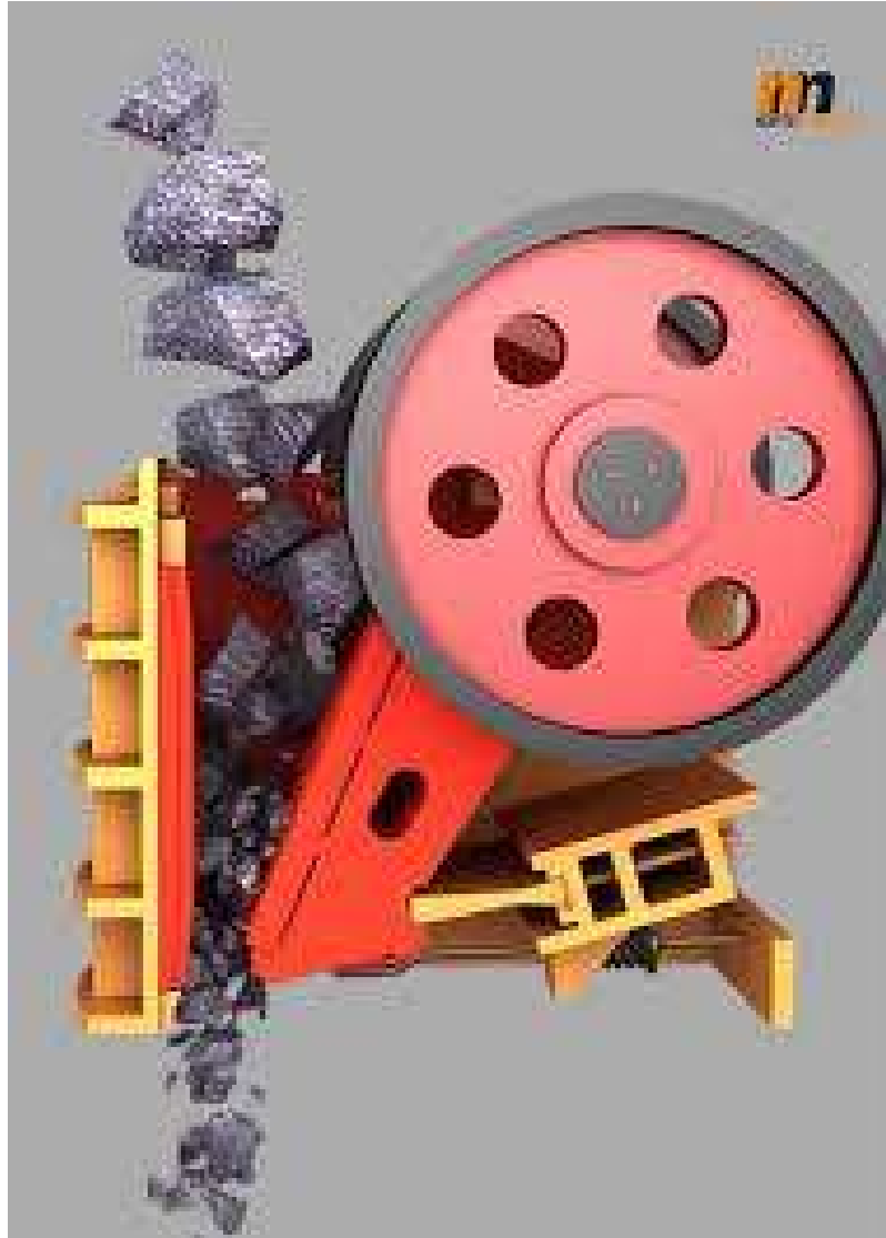
Figura 2. Esquema del funcionamiento de una chancadora de quijadas.
