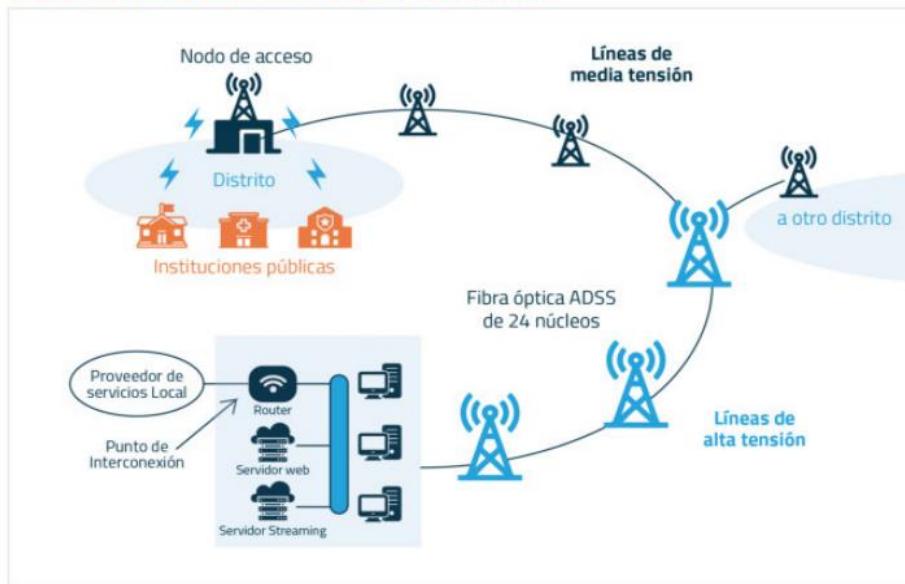
Red de Transporte sobre líneas de alta y media tensión
