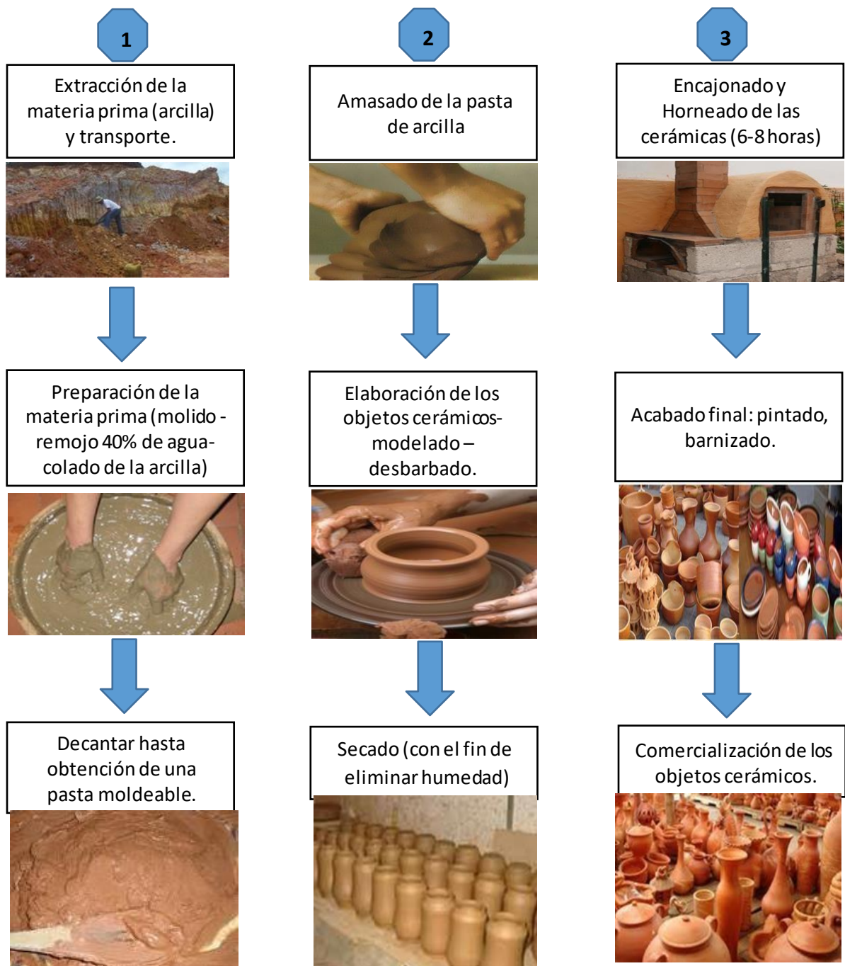
Figura 1. Proceso de elaboración artesanal de vasijas de barro
