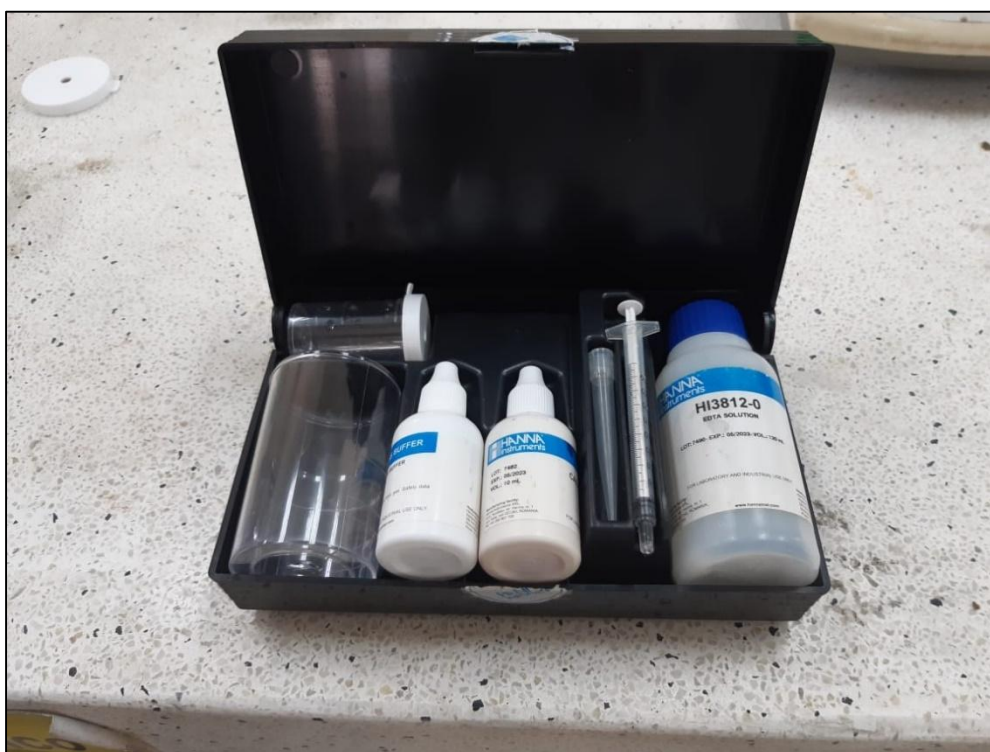
Figura 28. Uso del kit de dureza total de la marca: Hanna, modelo: HI3812 para la medición del parámetro dureza total
