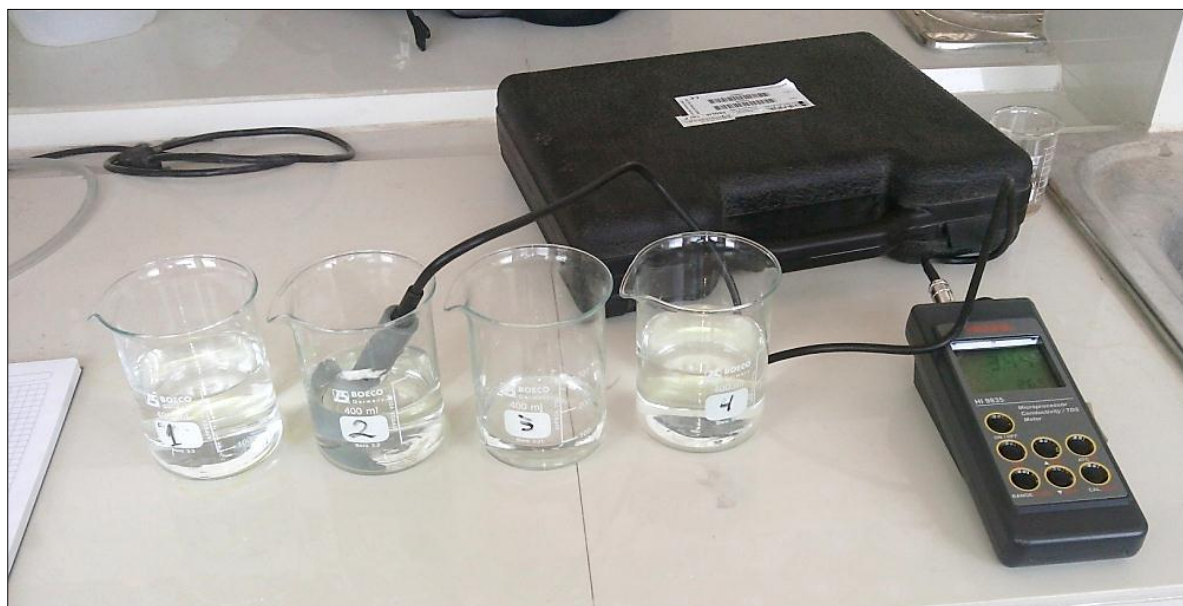
Figura 25. Uso del coductímetro de marca: Orión, modelo: 1750 para la medición del parámetro conductividad
