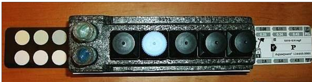
Figura 27. Uso del kit de prueba de color usando la escala de Hazen de la marca: Merck, modelo: 14421 para la medición del parámetro color
