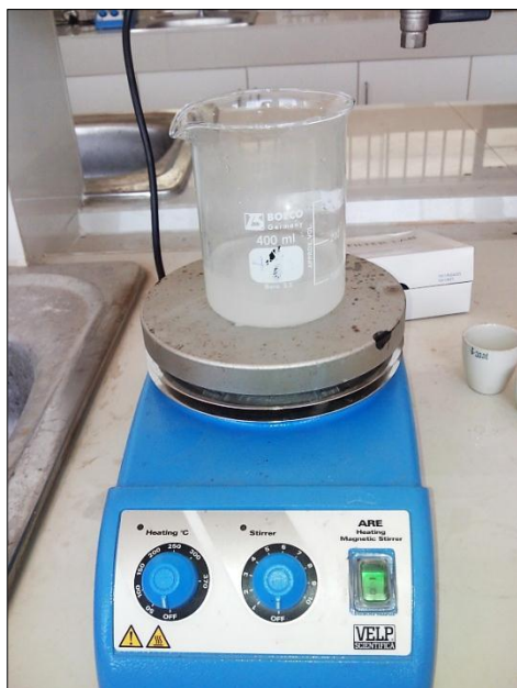
Figura 30. Determinación por el método gravimétrico para el parámetro sulfatos
