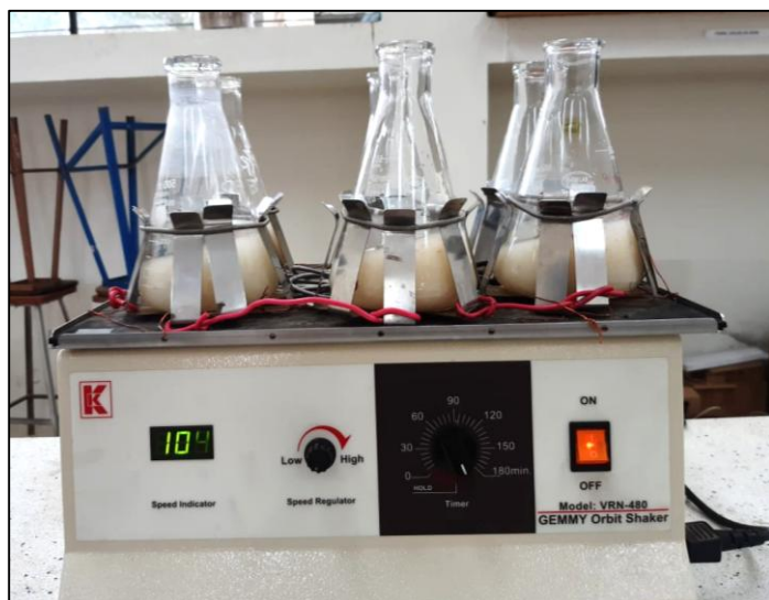
Figura 21. Etapa de la coagulación y floculación en el equipo de agitación orbital Shaker
