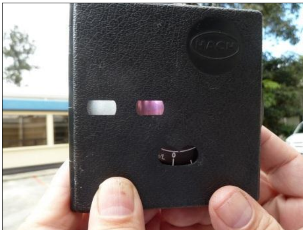
Figura 18. Uso del kit de cloro libre de marca: Hach, modelo: CN-66F para la medición del parámetro cloro residual
