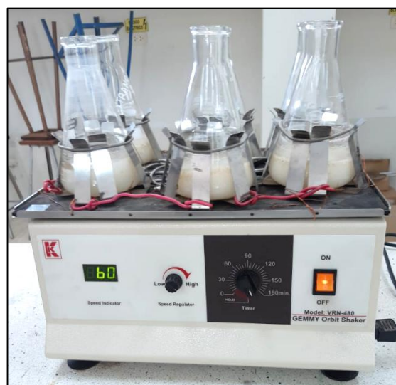
Figura 21. Etapa de la coagulación y floculación en el equipo de agitación orbital Shaker
