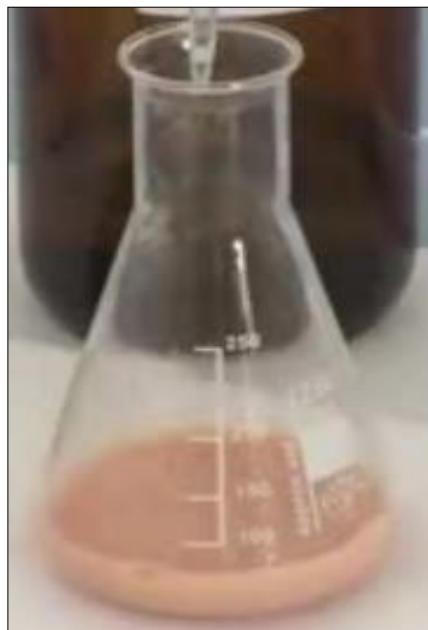
Figura 29. Titulación por el método volumétrico para la determinación del parámetro cloruros
