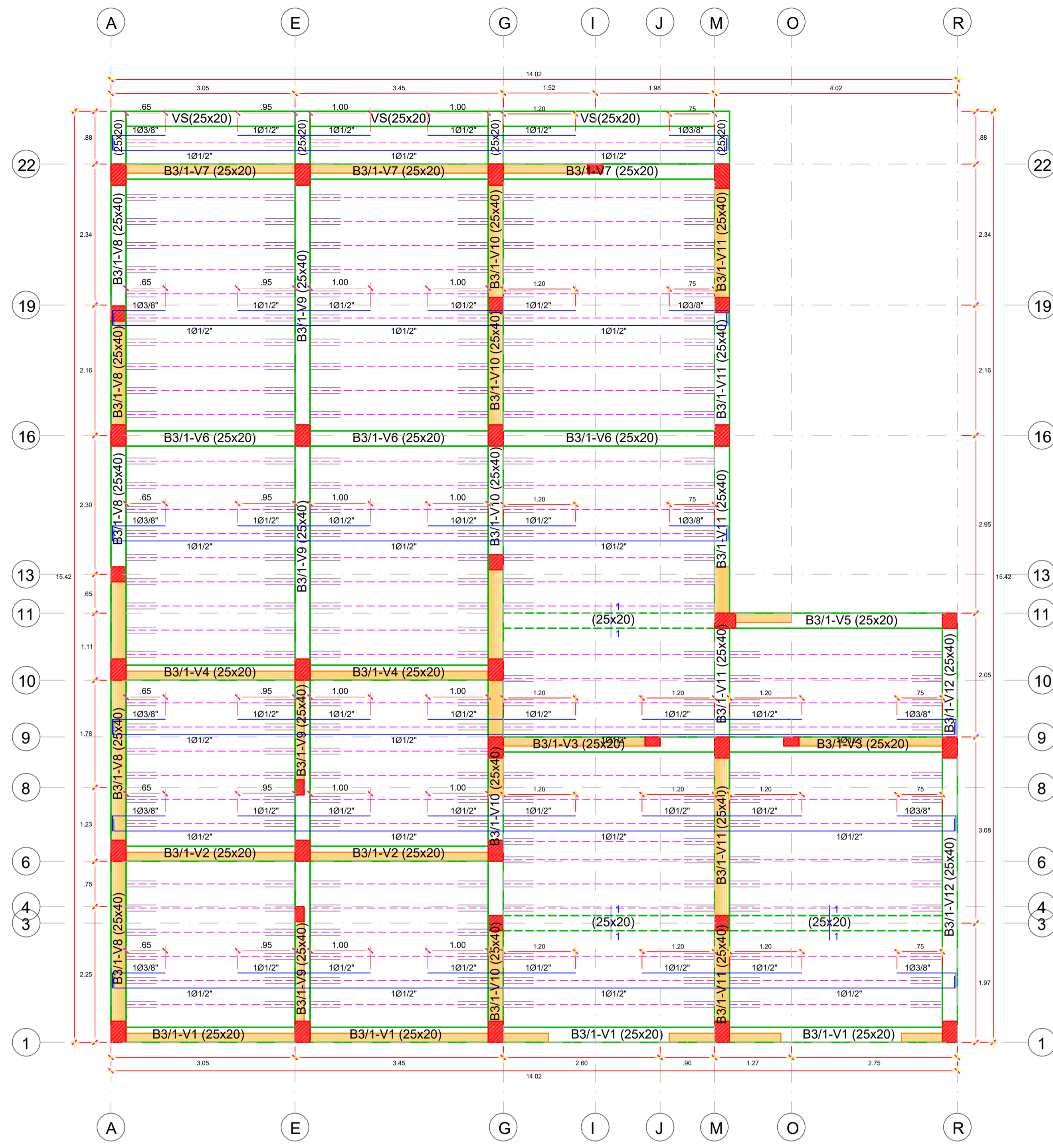
LOSA ALIGERADA PRIMER PISO (BLOQUE 03) LOSA ALIGERADA H=0.20m. S.C. = 250 Kg/m 2 (PROYECCIÓN A FUTURO) ESC. 1/30
