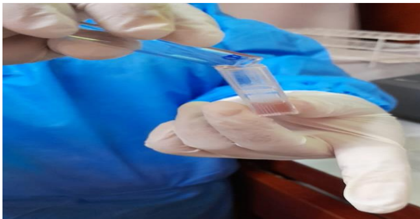
Colocando las celdas en el espectrofotómetro para la lectura
