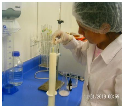
Figura 82. Medición de la densidad de la leche
