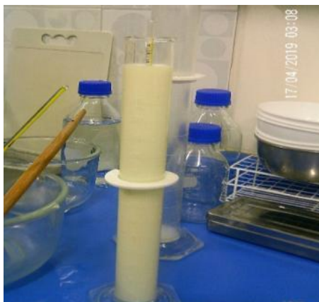
Figura 85. Medición de la densidad de la mezcla óptima
