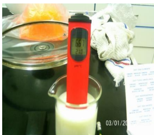
Figura 83. Medición del pH de la leche
