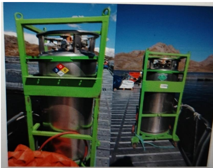
Fig. 1. Cuando hay bajo oxígeno se inyecta en los pulpos ( Criogénicos – mangueras ). Foto de la empresa “mar andina s.a.c” pasco (2020)
