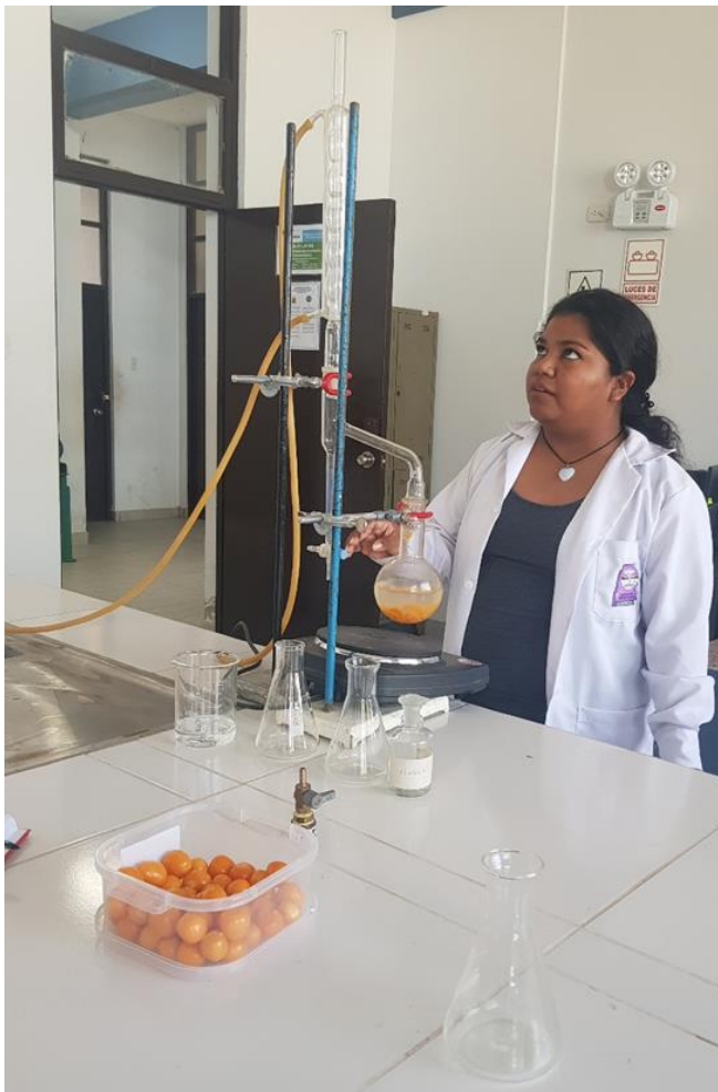
Figura 8. Extracción del caroteno (Recuperación del solvente)
