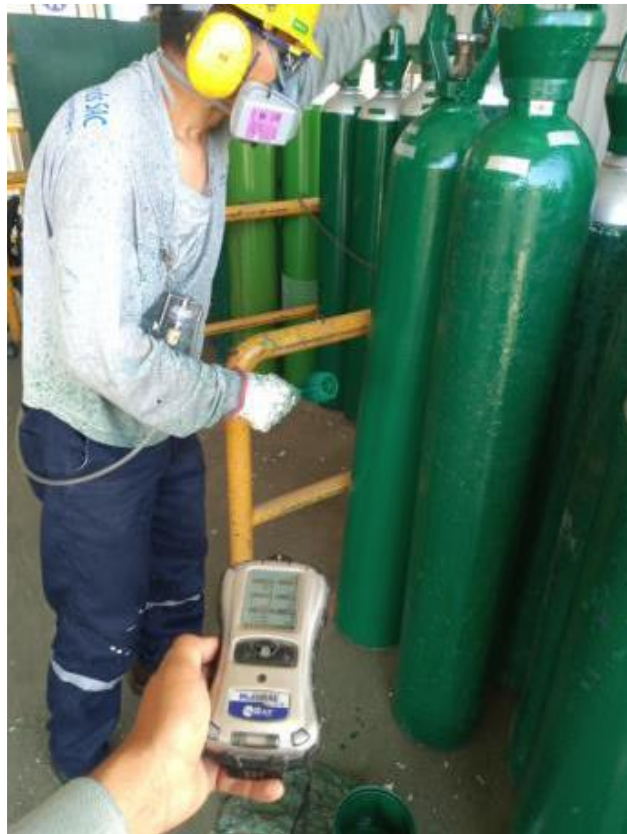
Foto: Monitoreo de COVs en la estación de llenado.
