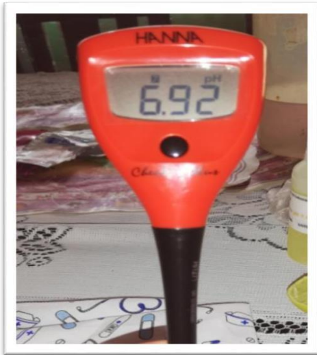
Fig.12: Se realizó la medición del pH inicial con el pH metro Hanna Hi 98100
