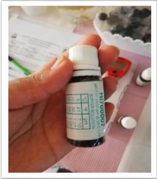
Fig.24: Se calibró el pH metro para obtener los resultados deseados.
