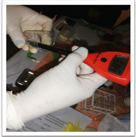
Fig.25: Se midió el pH a los 5 minutos después luego de escupir en los vasos de acrílico (mezcla del arándano y saliva).
