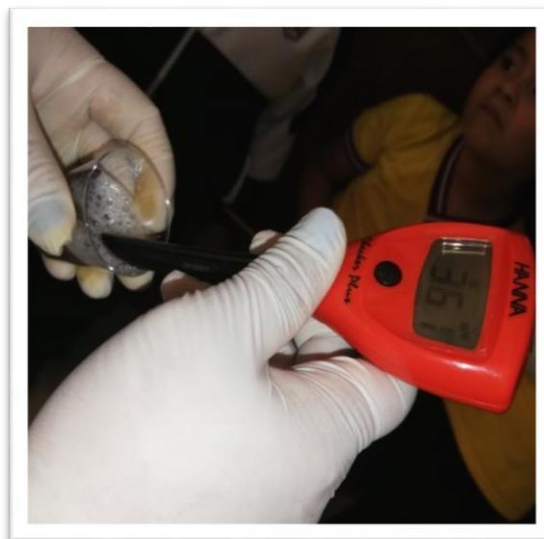
Fig.17: Se midió el pH del arándano y se colocó el resultado en la hoja de recolección de datos.
