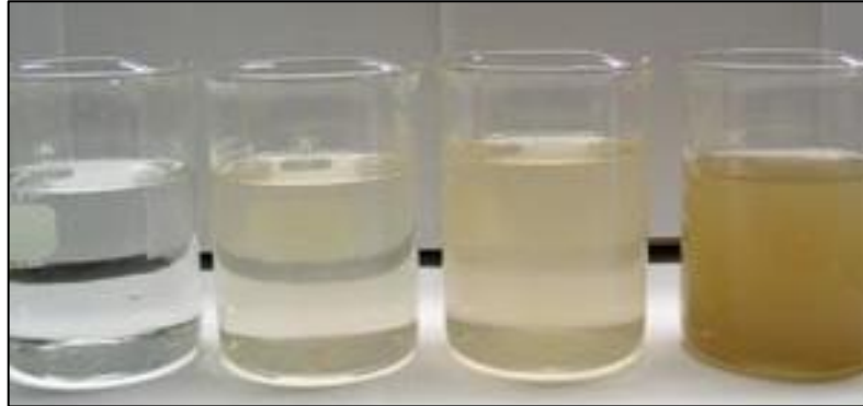
Figura 4. Turbidez del agua ocasionada por la arcilla.
