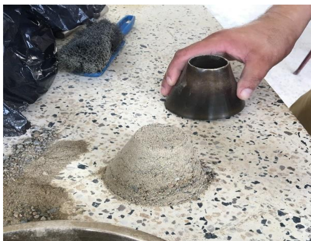
Imagen 11: El agregado a tomado la forma de un cono tronco lo cual muestra que todavía no está en estado superficialmente seco
