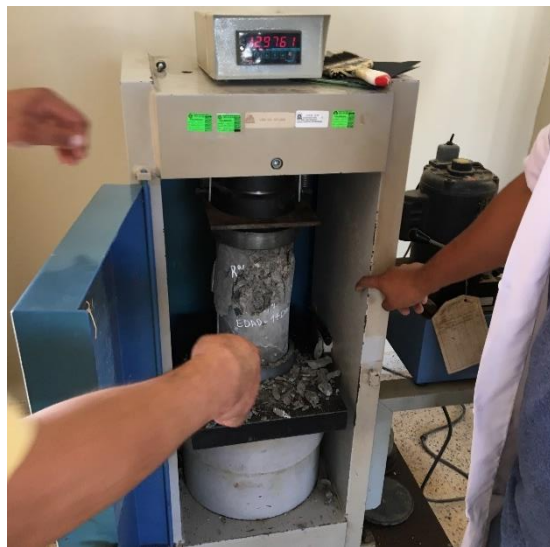
Imagen 20: Ensayo de ruptura del Testigo de Concreto
