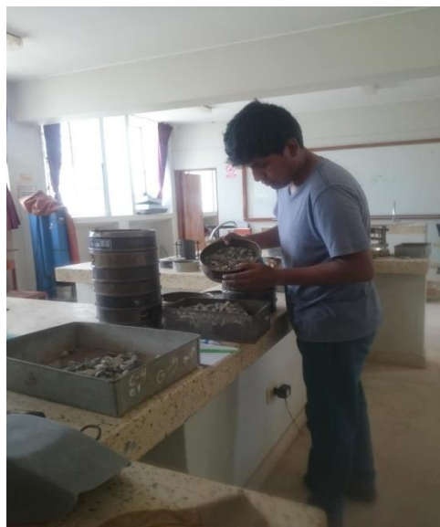
Imagen 2: Colocación del material grueso dentro de los tamices
