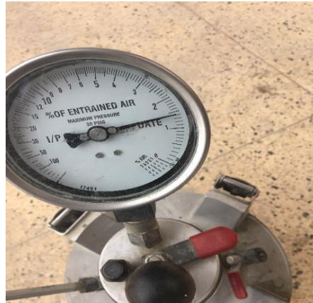
Imagen 19: Momento de la toma de la lectura del porcentaje de vacíos.
