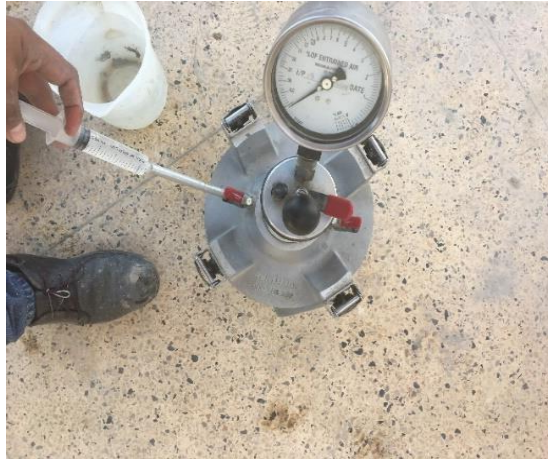
Imagen 18: Introducción de Agua en el molde
