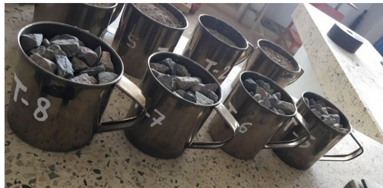
Imagen 8: Muestras antes de ingresar al horno
