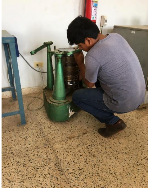
Imagen 3: Colocamos los Tamices en la Tamizadora Mecánica
