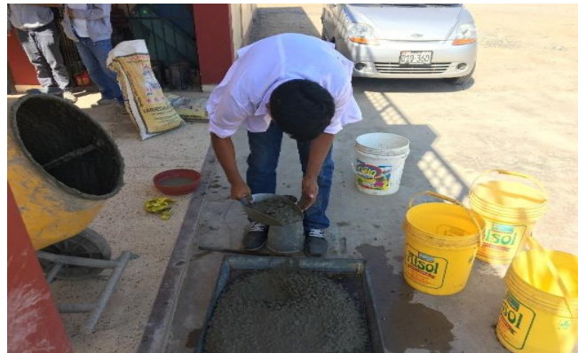
Imagen 13: Llenado de la probeta cónica
