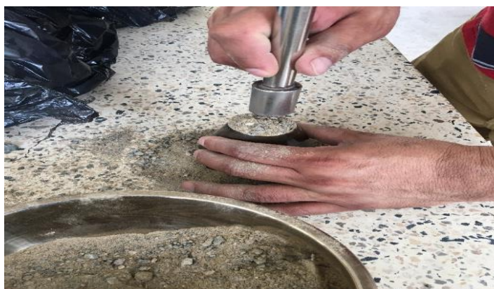
Imagen 10: Muestra el apisonamiento del agregado fino
