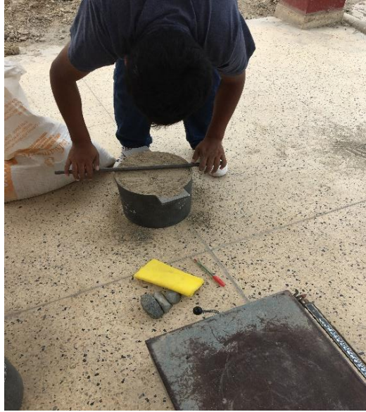
Imagen 6: Enrazado del agregado
