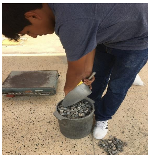
Imagen 5: Colocación del Agregado Grueso en el Recipiente
