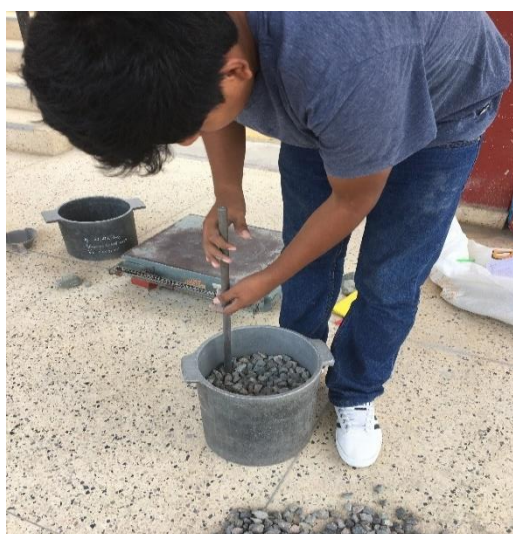
Imagen 7: Apisonamiento de los agregados
