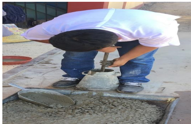
Imagen 14: Compactación del concreto con una varilla metálica
