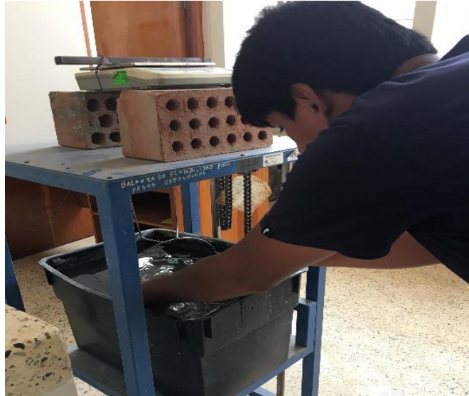
Imagen 9: Obtención del peso sumergido del agregado grueso
