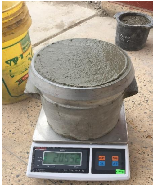
Imagen 17: Lleno de concreto y se procedió a tomar lectura de su peso
