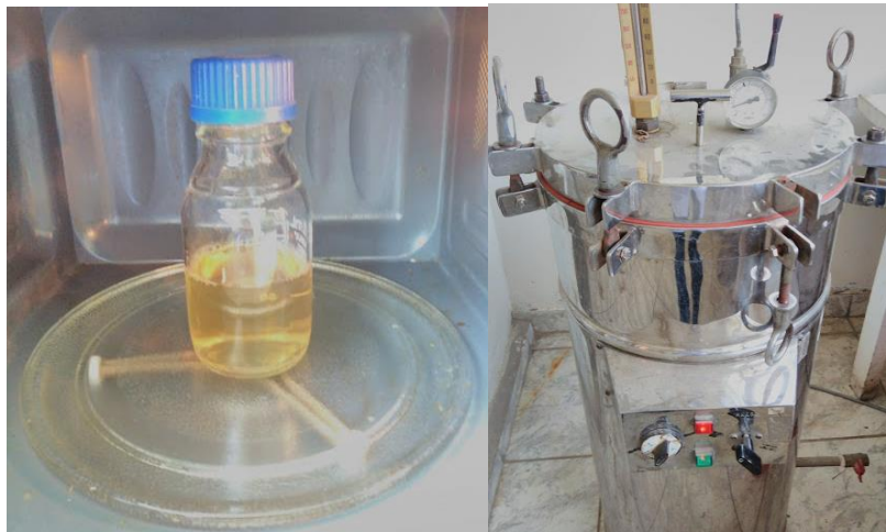
Ilustración 9.- Preparación del agar SBD y esterilización en autoclave. Fuente: Autor
