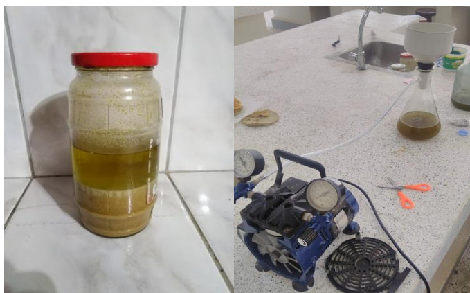
Ilustración 6.- Fase de Maceración y filtración a vacío. Fuente: Autor
