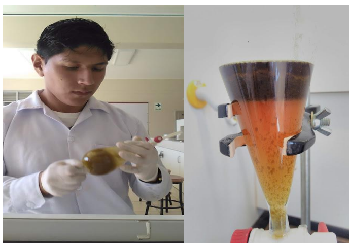
Ilustración 8.- Extracción butanólica/acuosa. Fuente: Autor
