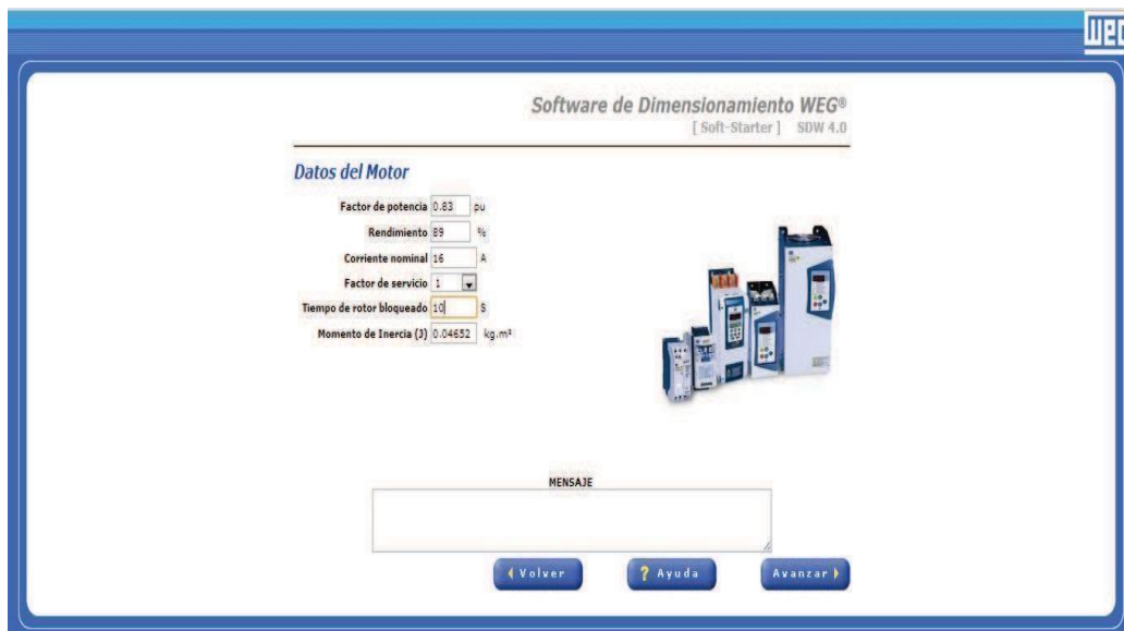
Fig. 31 Ingreso de otros datos del motor necesarios para el dimensionamiento WEG.
