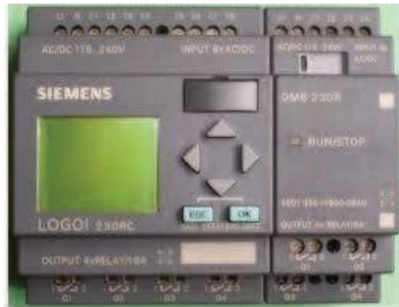
Fig. 19: Logo 230RC con módulo de expansión utilizado en el tablero de control.
