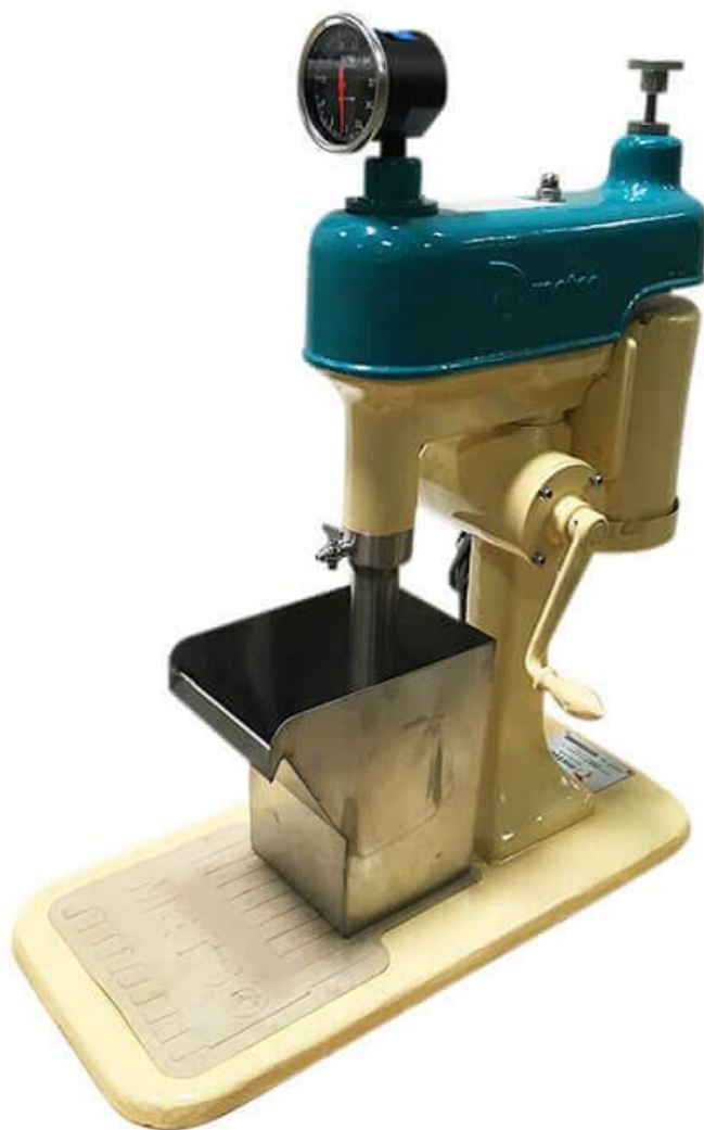
Fig. 16. Celda de flotación Denver [5]
