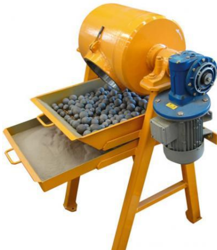
Fig. 15. Molino de bolas de laboratorio [5]
