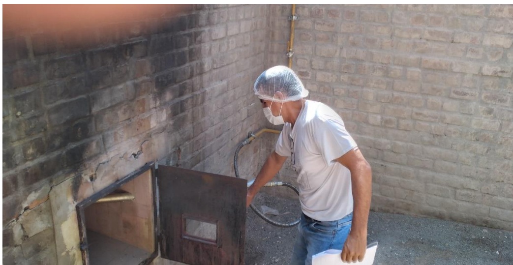
Figura 5.27 Horno con tapa metálica y combustible a gas natural.
