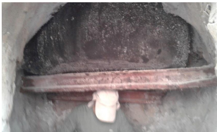
Figura 5.17 Fondo de cobre apoyado o sentado sobre dos rieles.
