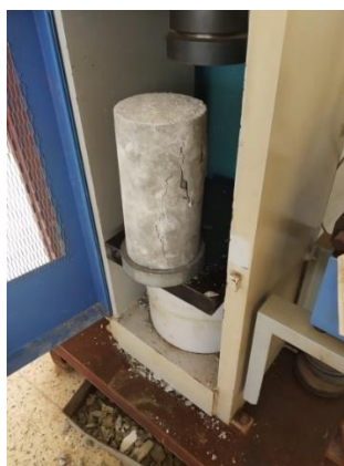
Imagen 39 Probeta después del ensayo de compresión.
