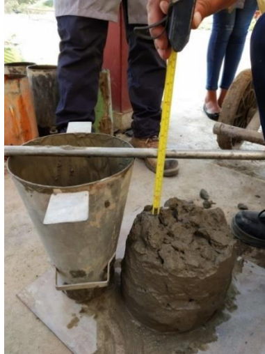
Imagen 3 Consistencia del concreto
