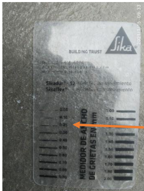
Imagen 25 Fisura de 0.25 medido con la regla de fisura con una resistencia de 140kg/cm2 Patrón
