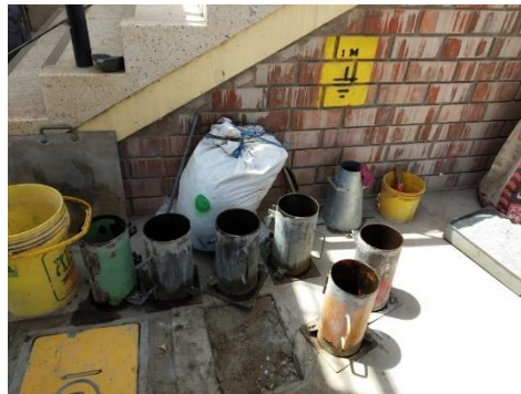
Imagen 30 Acondicionamiento del molde.
