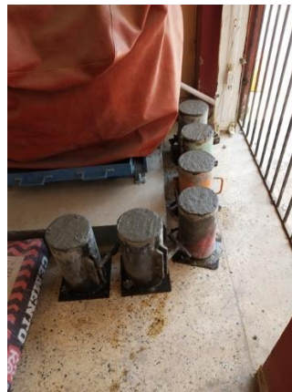
Imagen 35 Probetas listas para el curado al día siguiente.
