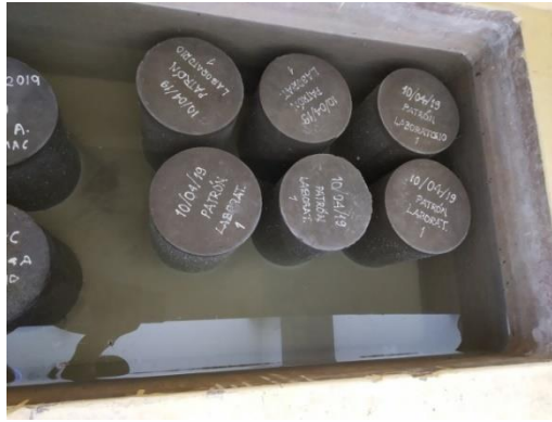
Imagen 36 Probetas en el pozo para el curado.
