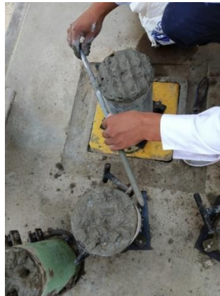
Imagen 34 Enrasando las probetas para el concreto.
