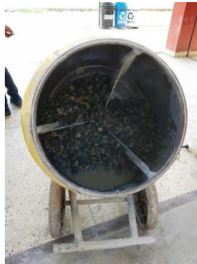
Imagen 32 Componentes del concreto en el trompo
