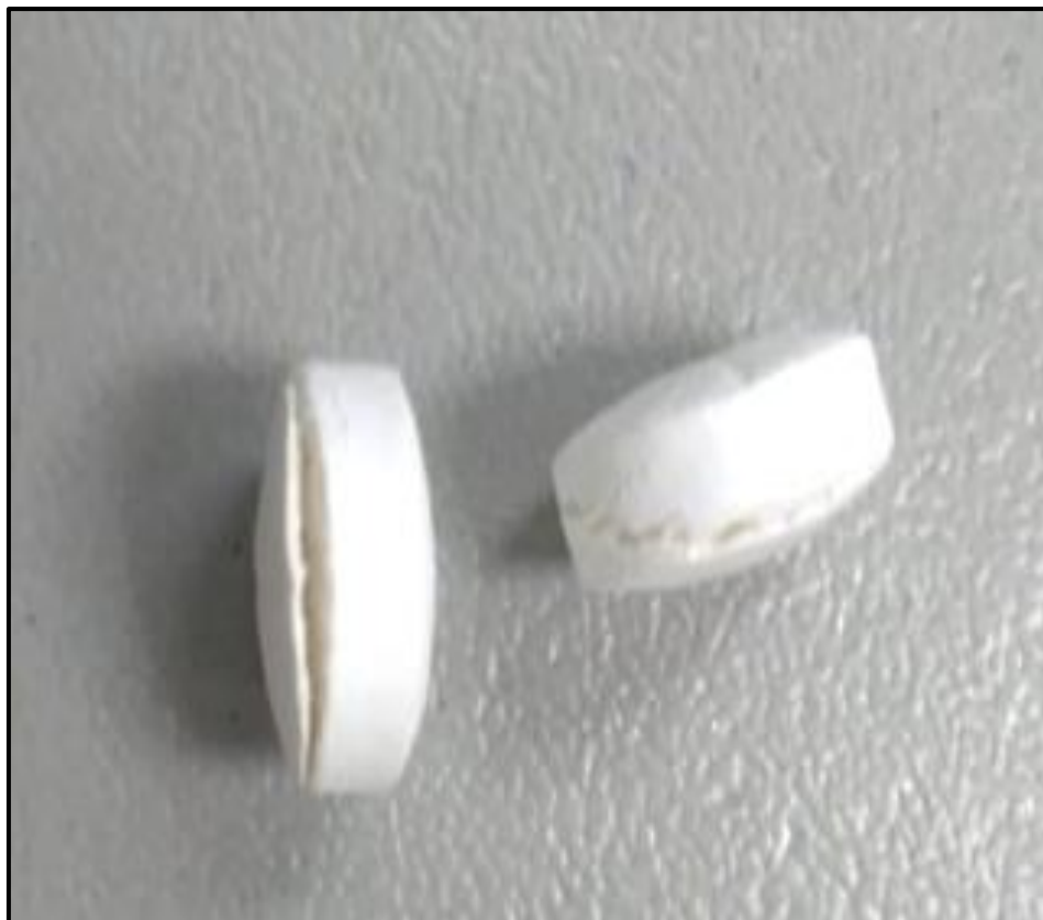
IMAGEN 3. TABLETAS DAÑADAS, OBTENIDAS POR LAS FORMULAS 2F Y 3F
