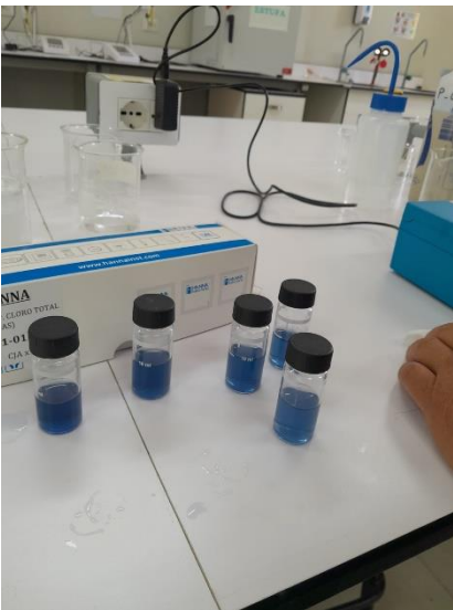
Foto de muestras (presencia de \text{PO}_4^{3-} ) foto de muestras (presencia de Zn)
