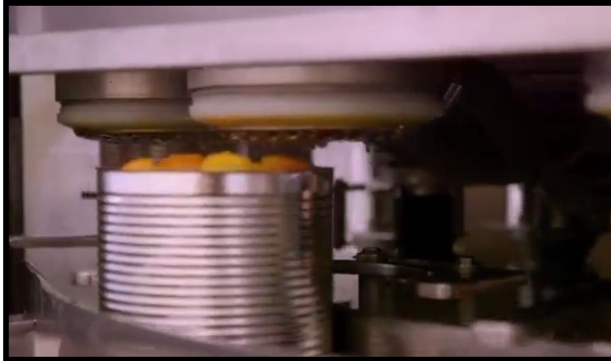
Fig. 4 Agregado de líquido de cobertura
