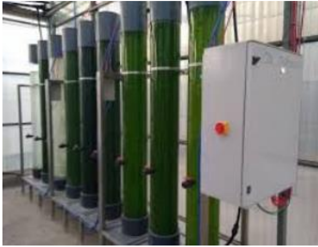
Figura 6. Fotobiorreactores en columnas. Fuente: [17].
