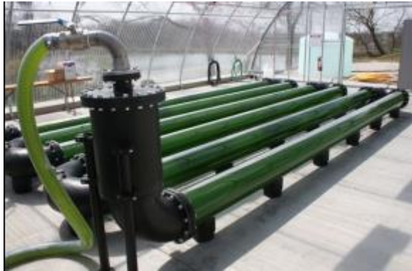
Figura 8. Fotobiorreactores en serpentina plano. Fuente: [17]
