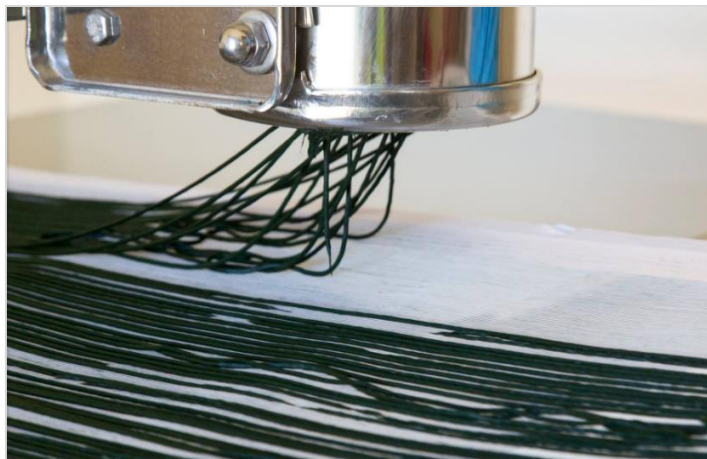
Figura 12. Pelletizado de la biomasa húmeda. Fuente: KORU ESPIRULINA (2016).
