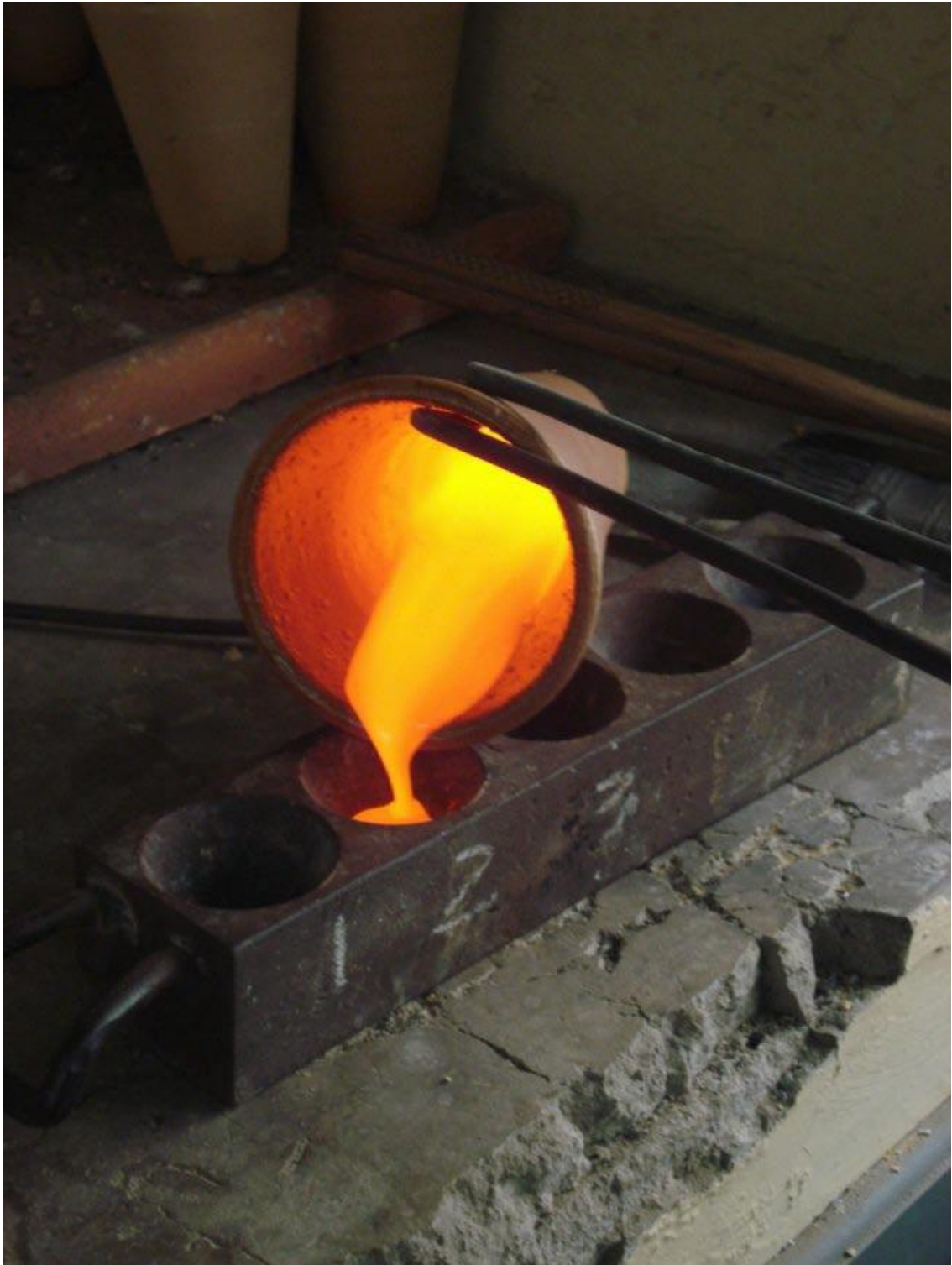
Fig. 6. Muestra fundida es vaciada en la lingotera.[5]
